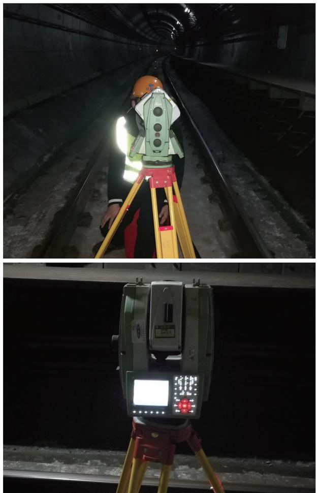
道现状几何形态。每次测量时在管片内壁上5度等角采集一组数据，0°、90°、270°处三处测点必须测量。在成果内按全站仪观测法列出90°-270°测线长度，监测结果包含隧道断面直径测量成果及与隧道设计内径的比较，0°-180°为竖向方向，但测线长度无法与隧道设计内径比较。在成果内按全站仪观测法列出测量结果，包含隧道断面直径测量成果及与隧道设计内径的比较，且各点反映隧道各拼装管片的相对变形情况。
